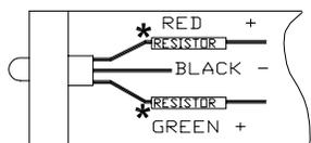
\* LED IS SET FOR 24VDC OPERATION. FOR 12VDC INPUT CUT OFF RESISTOR
